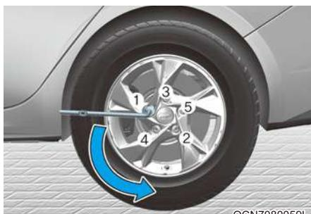
6. Ослабить против часовой стрелки гайки крепления колеса, но не откручивать их полностью, пока колесо не будет поднято над землей.
