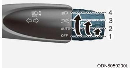
Для управления фарами поверните кнопку на конце рычага в одно из следующих положений:
