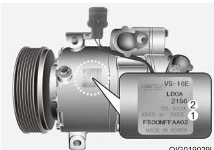
На этикетке компрессора указаны модель, номер детали поставщика, серийный номер, тип хладагента (1) и тип холодильного масла (2).
