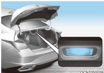
Плафон освещения багажника включается при открытии багажника.
