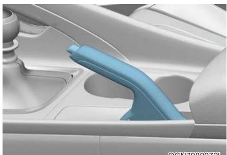
Проверьте ход стояночного тормоза, подсчитав количество слышимых «щелчков», полностью отпустив его из отжатого положения. Также стояночный тормоз должен самостоятельно обеспечивать удержание автомобиля на достаточно крутом уклоне. Если ход педали больше или меньше значения, указанного в технических характеристиках, рекомендуется произвести обслуживание системы у официального дилера HYUNDAI.
