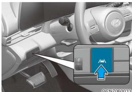
После того как вы переведете кнопку «ENGINE START/STOP» (Запуск/остановка двигателя) в положение «ON» (Вкл.) и нажмете кнопку «Lane Safety» (Безопасность движения по полосе), функция включится, а на приборной панели начнет светиться белый индикатор
