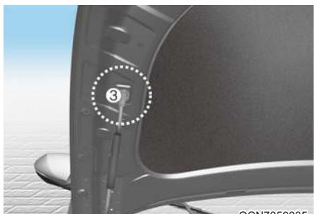
5. Удерживайте капот в открытом положении с помощью опорной стойки (3).
