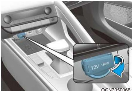
Розетка предназначена для подключения мобильных телефонов и других электроприборов, рассчитанных на питание от автомобильной электросистемы.
