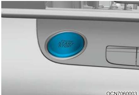
При открытии передней двери загорается кнопка «Engine Start/Stop» (Запуск/остановка двигателя). После закрытия двери она горит еще 30 секунд (при наличии).
