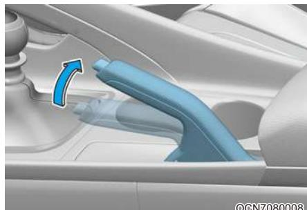
Перед тем как покинуть автомобиль, обязательно задействуйте стояночный тормоз. Чтобы задействовать стояночный тормоз:
