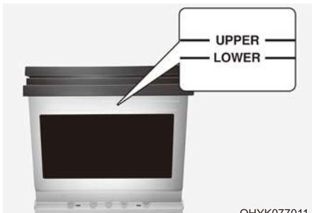
Если автомобиль оснащен аккумулятором с отметками «LOWER», MIN (Нижний уровень (Мин.)) и «UPPER», MAX (Верхний уровень (Макс.)) на боковой стенке, в нем необходимо проверять уровень электролита.
