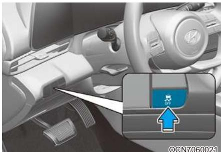
Электронная система динамической стабилизации (ESC) поддерживает устойчивость автомобиля при поворотах. Система ESC проверяет направление, в котором поворачивается рулевое колесо, и направление, в котором автомобиль движется на самом деле.
