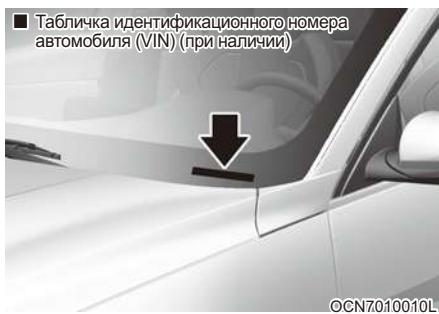
Номер VIN также указан на табличке, прикрепленной к верхней части приборной панели. Номер на табличке можно легко разглядеть снаружи через лобовое стекло.
