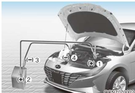
4. Подключите соединительные кабели точно в той последовательности, которая показана на рисунке. Сначала подключите один пусковой кабель к красному (положительному +) выводу аккумуляторной батареи от внешнего источника на вашем автомобиле (1).
