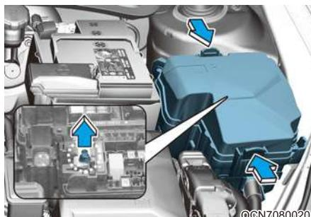
Если самовосстанавливающийся предохранитель перегорел, его необходимо извлечь следующим образом.
