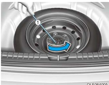
Если сложно вывернуть прижимной барабанковый болт колеса вручную, его можно легко вывернуть, используя ручку домкрата.
