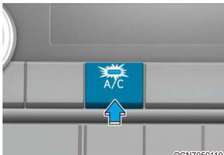
Для включения системы кондиционирования в ручном режиме нажмите на кнопку A/C (при этом загорится расположенный в ней индикатор).
