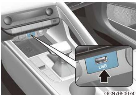
Порт USB можно использовать для подключения устройств USB.
