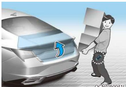
На автомобиле с интеллектуальным ключом дверь багажника можно открыть дистанционно с помощью системы интеллектуального открывания двери багажника.
