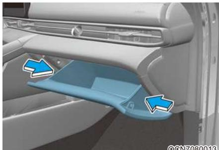
1. Нажмите на перчаточный ящик с обеих сторон, как показано на рисунке. Это обеспечит высвобождение фиксирующих штифтов из гнезд, и перчаточный ящик опустится.
