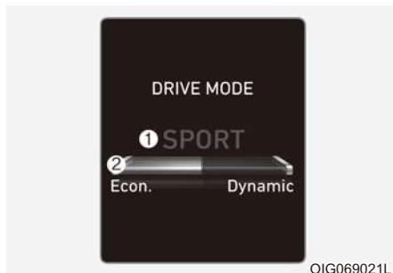
На экране отображается режим движения, выбранный водителем (1), и датчик стиля вождения водителя (2), демонстрирующий стиль вождения водителя.
