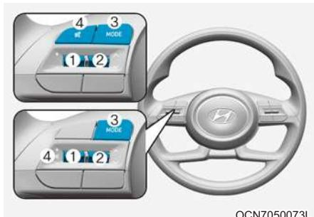
Для удобства установлены переключатели управления аудиосистемой на рулевом колесе.
