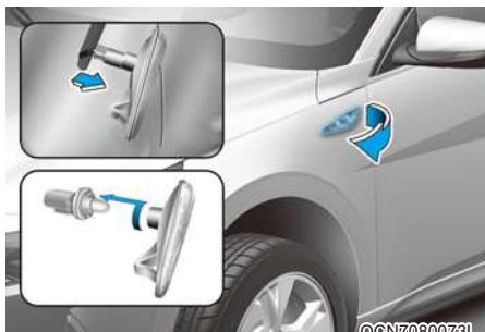
1. Извлеките узел лампы из автомобиля поддев рассеиватель и вытащив узел.
