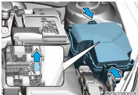
5. Извлеките предположительно неисправный предохранитель. Для этого воспользуйтесь специальным приспособлением, которое находится в панели предохранителей в моторном отсеке.
