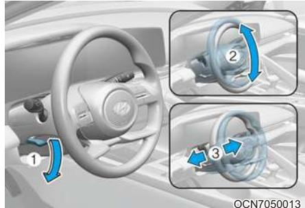
Процедура изменения угла и высоты положения рулевого колеса:
