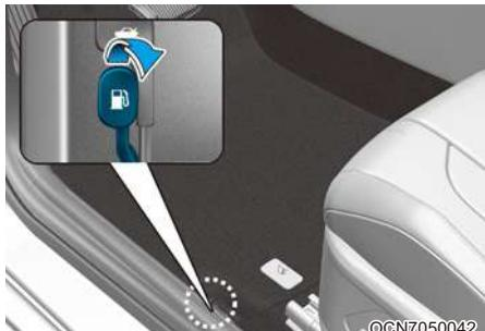
Крышка горловины топливного бака открывается ручкой изнутри транспортного средства.
