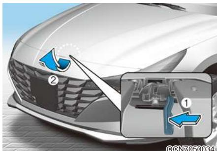
3. Подойдите к автомобилю спереди, слегка приподнимите капот, потяните вверх за вторую защелку (1), расположенную изнутри по центру капота, и приподнимите капот (2).
