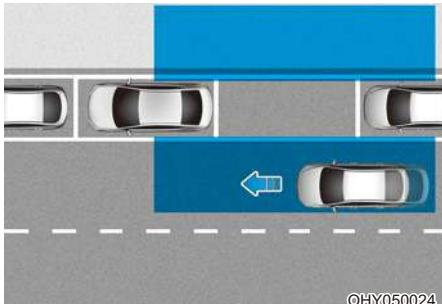
Если после остановки автомобиля и открытия пассажирской двери будет обнаружено приближающееся сзади транспортное средство, система контроля безопасного выхода предупредит водителя с помощью сообщения и звукового сигнала, чтобы предотвратить столкновение.
