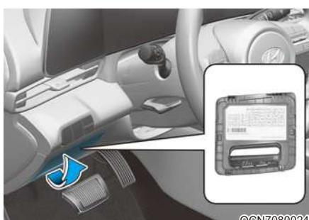
С внутренней стороны крышек блока реле и предохранителей находится этикетка с указанием названий предохранителей/реле и их номинальных характеристик.
