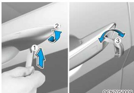
1. Нажмите на рычажок, расположенный под крышкой механического ключа. (1)
