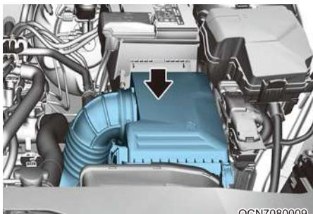
Воздушный фильтр можно очистить для проверки с помощью сжатого воздуха. Не пытайтесь промывать или прополаскивать его, так как это приведет к повреждению фильтра. В случае сильного загрязнения воздушный фильтр нужно заменить.
