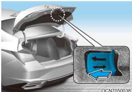
Ваш автомобиль оснащен рычагом экстренного открытия крышки багажника. Если кто-то случайно оказался запертым в багажнике, последний можно открыть, переместив рычаг в направлении стрелки и толкнув крышку багажника.
