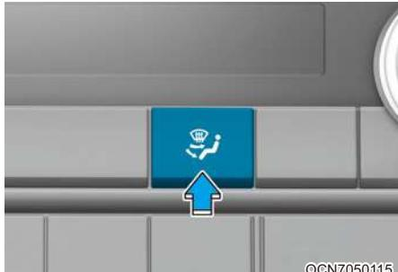
Переключатель режимов управляет направлением потока воздуха через вентиляционную систему.
