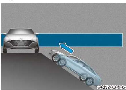
Возможности функции обеспечения безопасности при пересеченном движении сзади могут быть ограничены при движении автомобиля на подъеме или спуске (или рядом с ними), и она может не обнаружить транспортное средство, приближающееся слева и справа. Если это произойдет, система может не предупредить водителя или не применить тормоза, когда это будет необходимо.
