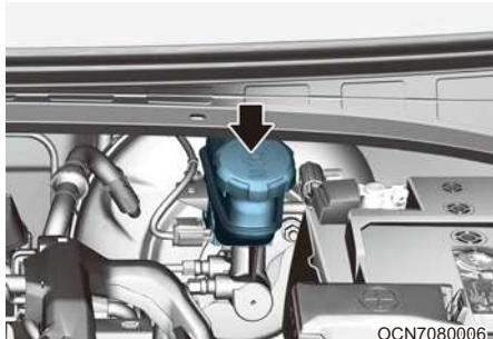
Периодически проверяйте уровень жидкости в бачке. Уровень жидкости должен находиться в пределах между отметками «MAX» (Макс.) и «MIN» (Мин.), нанесенными на боковой части бачка.
