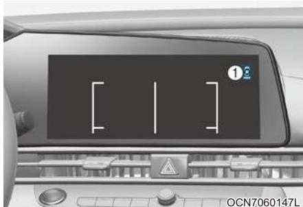
Если нажать на пиктограмму (1), на экране появится вид сверху, на котором будет показано расстояние до задней части автомобиля во время парковки.
