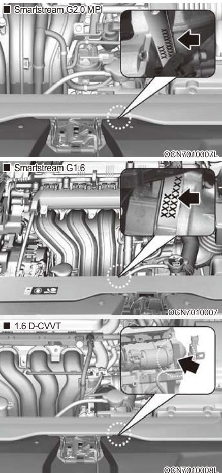
Номер двигателя выбит на блоке цилиндров, как показано на иллюстрации.
