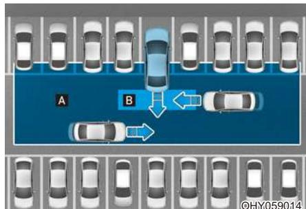
[A]: рабочий диапазон системы оповещения об объектах, движущихся в поперечном направлении сзади автомобиля ,
