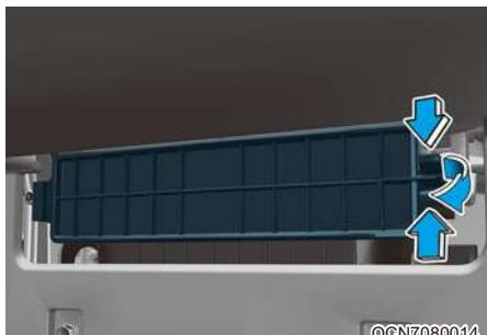
2. Снимите кожух фильтра системы климат-контроля, одновременно нажав на замок с правой стороны крышки.
