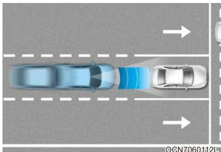
Система помощи по предотвращению переднего столкновения помогает обнаруживать и отслеживать транспортные средства по ходу движения, обнаруживать пешеходов или велосипедистов на проезжей части, а также предупреждает водителя о возможном столкновении с помощью предупреждающего сообщения и звукового оповещения и при необходимости применения экстренного торможения.
