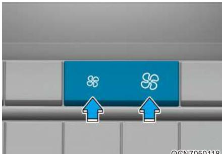
Скорость вращения вентилятора можно установить с помощью отдельного переключателя.
