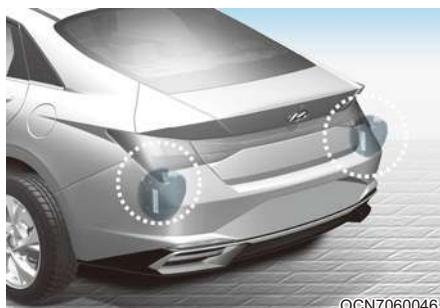
Задние угловые радары представляют собой расположенные внутри заднего бампера датчики, которые служат для обнаружения объектов с боковой стороны и позади автомобиля. Следите за чистотой поверхности заднего бампера с целью обеспечения надлежащей работы системы контроля безопасного выхода.
