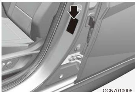
На сертификационной табличке автомобиля (которая находится на средней стойке со стороны водителя или пассажира) имеется идентификационный номер автомобиля (VIN).
