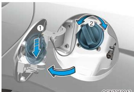
3. Потяните лючок горловины топливного бака (1), чтобы открыть его полностью.
