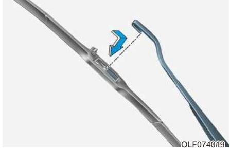
2. Нажмите на фиксатор и сдвиньте узел щетки вниз.
