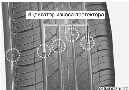
При равномерном износе шины поперек протектора становится виден индикатор износа в виде сплошной полосы. Это значит, что оставшаяся толщина протектора нашине составляет менее 1,6 мм. В этом случае заменитешину.
