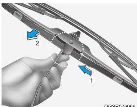
2. Поднимите зажим щетки стеклоочистителя. Затем потяните вниз и снимите узел щетки.
