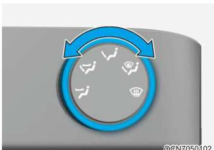
Ручка выбора режима управляет направлением потока воздуха через вентиляционную систему.
