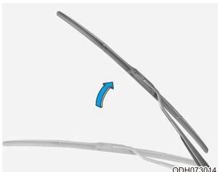
1. Поднимите рычаг стеклоочистителя и поверните узел щетки так, чтобы был виден пластмассовый фиксатор.
