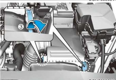
3. Вставьте крышку воздухоочистителя в шарнир (2) и зафиксируйте зажим (3) после закрытия крышки.
