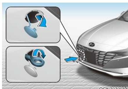
2. Снимите крышку с отверстия, нажимая на нижнюю часть крышки на бампере.
