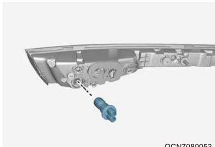
3. Извлеките патрон, поворачивая его против часовой стрелки до тех пор, пока выступы на патроне не совпадут с прорезями на узле.
