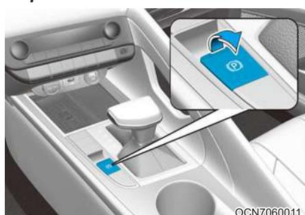
**Включение EPB (электрического стояночного тормоза)**
